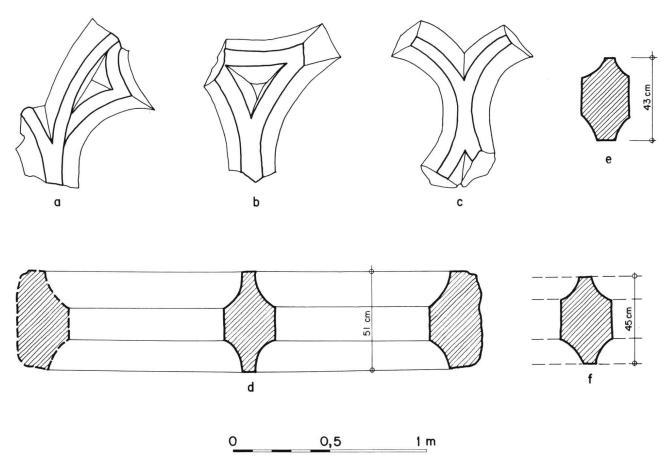
Fig. 19 Eléments de cadres, de meneaux et de remplages provenant de fenêtres gothiques tardives, détruites en 1897. Fenêtre 1: a, b, c, fragments de remplage; d, morceaux de cadre et de meneau. Fenêtre 2: e, fragment de meneau. Fenêtre 3: f, fragment de meneau
