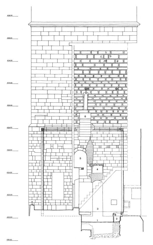
Abb. 13 Nordseite des Chorturmes mit den untersten beiden Turmgeschossen:
