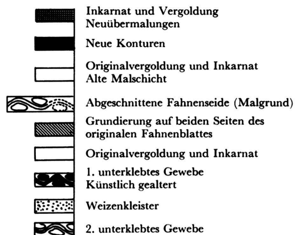
Abb. 14 Standarte mit dem heiligen Johannes, Altes Zeughaus Solothurn (Inv. 1135). Querschnittzeichnung des Fahnenblattes mit Schichtenabfolge
