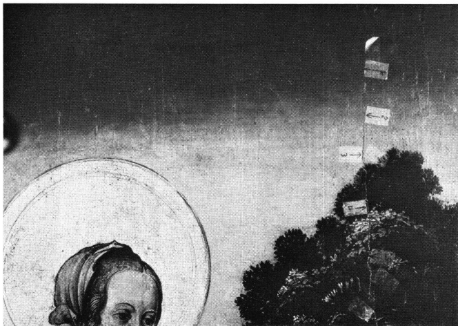
Abb. 2 Detail der Veilchenmeistertafel mit Rissen und großem Bruch. Die nummerierten Pfeile weisen auf Meßstellen
