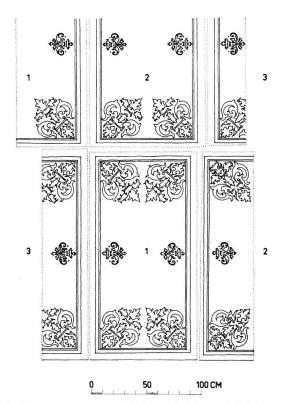
Abb. 9 Pruntrut, Jesuitenkirche. Farbige Holzdecke (der nachgotischen Kirche), die unter der barocken Stuckdecke noch vorhanden ist. Nach den Aufnahmen und den Pausen gezeichnet und ergänzt. Es fehlt die Deckleiste zwischen den Füllungen, die für die Ausführung der Stuckdecke entfernt worden ist
