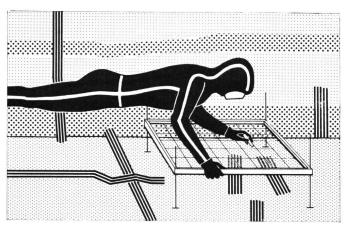
Abb. 7 System zum maßstabgetreuen Zeichnen unter Wasser. Auf dem Raster liegt eine Plexiglasplatte, auf die mit Lippenstift gezeichnet wird
