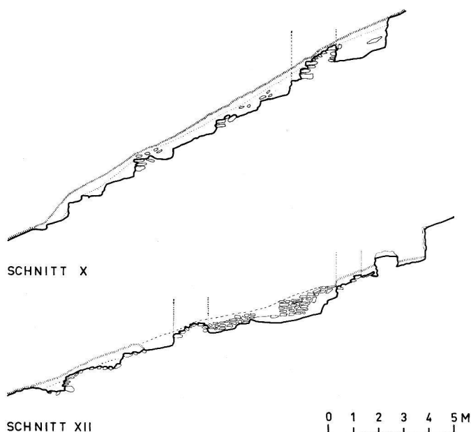
Abb.20 Castello di Tegna. Schnitt X durch die Ringmauer im Süden des Baues 1 und Schnitt XII durch den Bau 1 (vgl. Plan Abb.26). Diese Schnitte zeigen die Steilheit des Geländes, das hier gegen die Forcola abfällt
