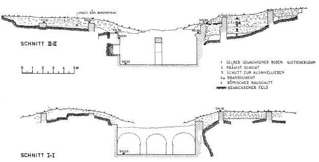
Abb. 9 Castello di Tegna. Hauptgebäude. Längs- und Querschnitt mit eingezeichneter Stratigraphie. Aus diesen Schnitten ist ersichtlich, wo im Mittelalter die Mauersteine für den Bau der kleinen Burg gewonnen wurden. Im Schnitt II-II war auf der linken Seite (Südseite) fast kein Mauerschutt mehr vorhanden. Aus der Zisterne hat man keine Steine herausgeholt, weil dies zu umständlich gewesen wäre
