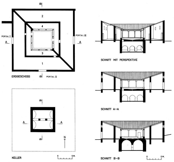
Abb. 6 Castello di Tegna. Hauptbau. Rekonstruktionsversuch
