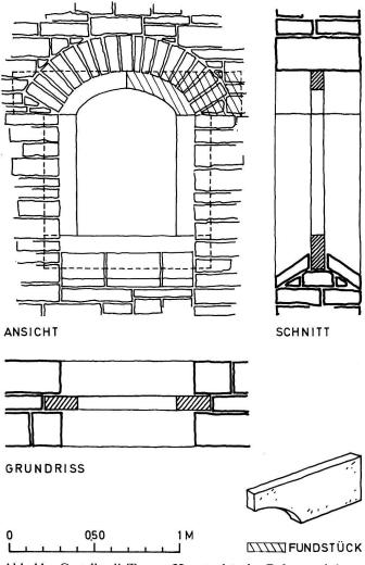
Abb. 11 Castello di Tegna. Hauptgebäude. Rekonstruktionsversuch eines Fensters. Im Hinblick auf die Klarheit der Zeichnung ist im Schnitt die Fugenzeichnung weggelassen
