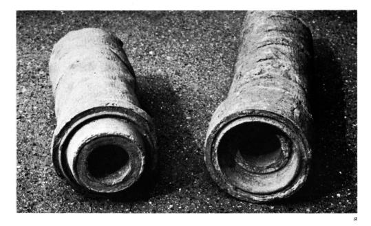
Tafel 35a. Zwei Röhrenstücke, links mit Zapfen, rechts mit Muffe. Der Verschluss weist zwei Anschläge auf. Das Zapfenstück links zeigt auf beiden Anschlägen einen ringförmigen Wulst, der in die Rille der Muffe (rechts) genau hineinpasst. (Slg. A. Gerster)
