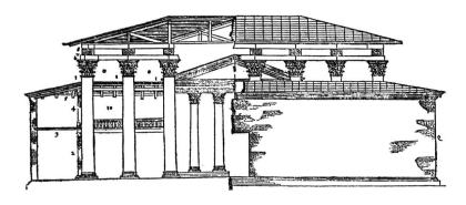
Abb. 3. Basilika von Fano des Vitruv. Aufriss und Längsschnitt. Grundriss vgl. Abb. 2.
