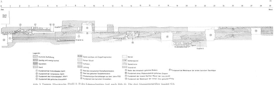
Abb. 3. Tuggen, Pfarrkirche. Profil A-B des Längsschnittes (vgl. auch Abb. 6). Die drei Alamannengräber fanden sich zwischen Laufmeter 12 und 14, östlich des Pfeilersockel-Fundamentes 10. Man beachte besonders die Niveauverhältnisse zwischen den Sohlen der frühmittelalterlichen und der romanischen Mauerfundamente am linken Bildrand zwischen Laufmeter 0 und 1. – Maßstab 1:100.
