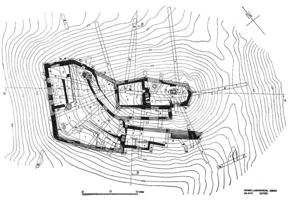
Abb. 6. Die ergänzten Mauerteile sind schraffiert
