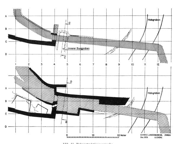
Abb. 11. Rekonstruktionsversuche Oben: Grundriss des Zugangweges, des Tors und der Brücken der ersten Bauetappe Unten: Grundriss des Zugangweges, des Zwingers und des Haupttors der zweiten Bauetappe
