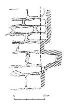
Abb. 10. Zürich, Fraumünster. SO-Ecke der Krypta der dritten Bauzeit. Eingreifen der östlichen Quaderwand in die südliche verputzte Längsmauer. Rand des beseitigten Fugenmörtels durch gestrichelte Linie angegeben
