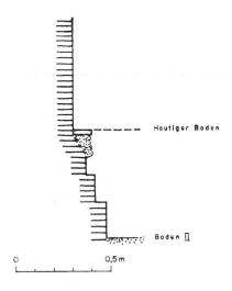
Abb. 19. Zürich, Fraumünster. Erdgeschoss des Südturms. Vertikalschnitt durch den Sockel der Einsatzmauer der fünften Bauzeit auf der Seite des Querschiffes
