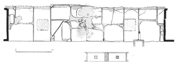
Abb. 16. Zürich, Fraumünster. Aufsicht auf die Bank des Nordfensters im Glockengeschoss des Südturms (vierte Bauzeit). Darunter Planrekonstruktion der ursprünglichen Aufbauten
