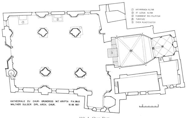
Abb. 1. Chur, Dom Grundriss mit Einzeichnung der Fundamente des Pulpitum und des Standorts der Werkstücke
