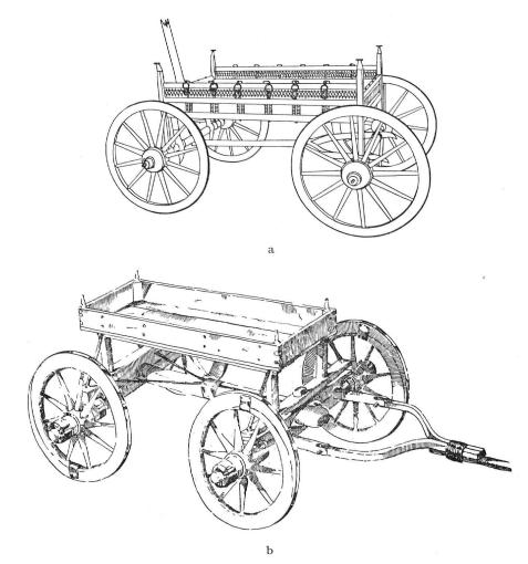
Abb. 44. Rekonstruktionszeichnungen der Eisenzeitwagen von Ohnenheim a und Bell b. Zu beachten: Bei der Rekonstruktion a ist die Vorderachse noch starr gehalten. Sie sollte aber durch Ergänzung eines darüber lagernden Reibscheits und des zentralen Reibnagels drehbar gestaltet sein, wie das bei der Rekonstruktion b zutrifft. (Die Rekonstruktion a zeigt die alte Auffassung, die Rekonstruktion b dagegen die richtige neue)
