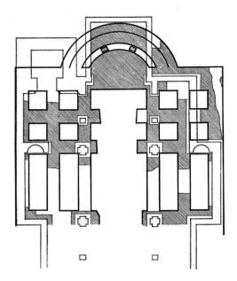
Abb. 7. Skizze zu Bauetappe B mit Umriss des heutigen Münsters. 1:500 (Entwurf und Ausführung wie Abb. 3).
