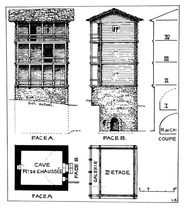
Fig. 5. Plan et élévation du ballios de Vissoie
