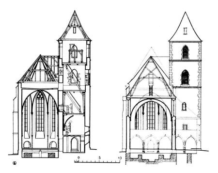
Abb. 5. Querschnitt durch Chor und Turm. — Querschnitt durch das Langhaus. Querschnitte durch die Kirche St. Alban in Basel. — Maßstab 1:500. — Aufgenommen vom Technischen Arbeitsdienst Basel unter Benützung der Pläne von Ingenieur Tschudy (1732) und der Aufnahmen von J. J. Stehlin d. J. 1845.
