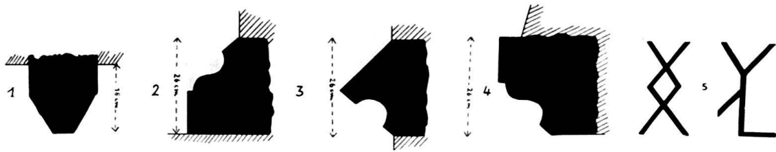
Abb. 3. Kirche St. Justus in Flums. Profile und Steinmetzzeichen des gotischen Baues.
