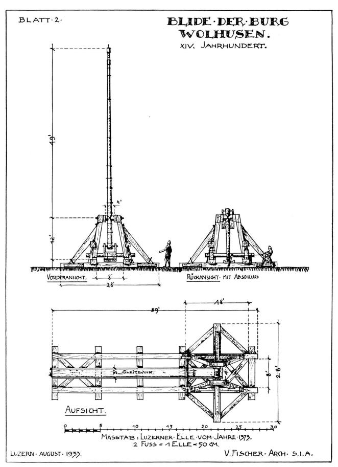
Abb. 4. Blide der Burg Wolhusen. Rekonstruktion. Oben: Vorderansicht und Rückansicht mit Abschuss. Unten: Aufsicht.
