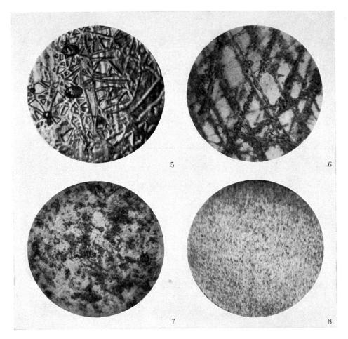
Fig. 5 — Altérations superficielles du verre. Sillons anastomosés encore plus prononcés. Eclairage par transparence. Gross.: 16 fois.
