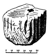
Abb. 5. a) Kapitell eines Pfeilers, Rekonstruktion, gezeichnet nach Angaben Dr. H. Kählers von H. Herzig, Architekt. b) Pfeilertrommel mit kreuzförmigem Aufzugloch.
