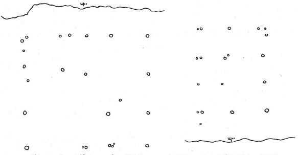
Abb. 3a. Grundriß des großen Pfahlhauses. Länge 7,5 m, Breite 6,5 m.
