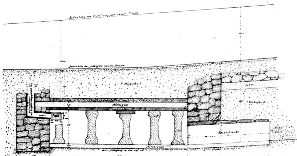
Die siebenundzwanzig reihenweise aufgestellten Tuffssäulen tragen 6 cm dicke, außerordentlich sorgfältig erstellte und gebrannte rechteckige Ziegelplatten, die in der Regel Dimensionen zu 0,64:0,67 m aufweisen und ist deren Anordnung in der Weise durchgeführt worden, daß jede der Platten auf je vier Säulenvierteln ruht. Die Tragkraft der mittleren Säule jeder Reihe ist in der Weise verstärkt worden, daß man auf deren Fläche noch eine über mehrere Platten reichende Ziegelplatte auflegte.
