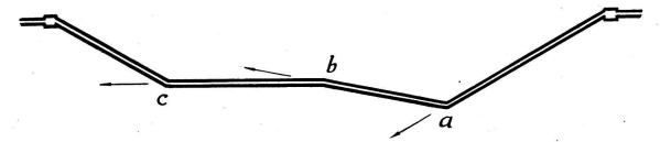
Abbildung 1. Sogenannte Knie einer Druckleitung.
