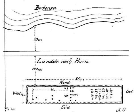
Skizze der römischen Pfahlanlage, entdeckt bei der Fundamentierung der neuen Ölfabrik des Herrn Schmiedheine in Horn a. B. den 15. Oktober 1916. Länge der eichenen Pfähle 1,5 m; Spitze 0,70 m im Kies; durchschnittliche Dicke 0,25 m. Einige Pfähle mit dreizackigem Kopf (Aufnahme von Faschinen?).
