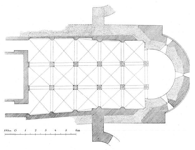
Abb. 13. Rekonstruktion des ursprünglichen Planes der romanischen Krypta. (Die schraffierten Teile sind vorhanden; die punktierten vermutungsweise ergänzt.)
