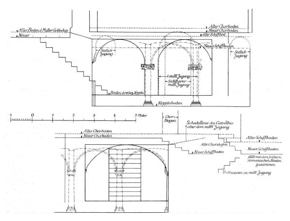
Abb. 8. Querschnitt und Längsschnitt der kleinen Krypta, ehemaliger und heutiger Zustand.
