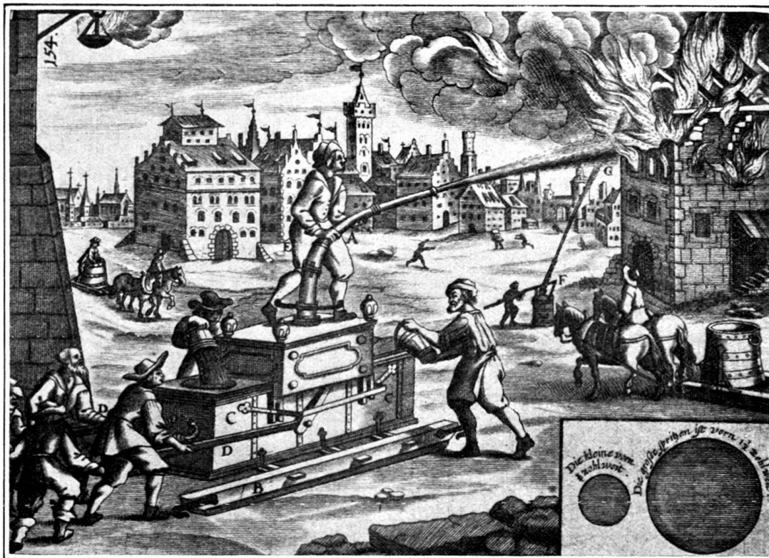
98. Hautschsche Feuerspritzen von 1 \frac{1}{2} und \frac{1}{2} zölligem Wasserstrahl. Man beachte auf dem Bildchen oben links die brennende Harzpfanne und unten die auf Schleifen gezogenen Wasserkufen. (Aus Wolfermann, S. 13.)
