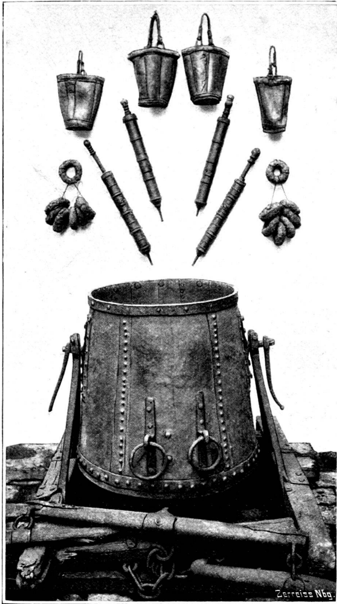
91. Nürnberger Löschgeräte: Kupferne Wasserkufe, 300 Liter fassend, auf Schleife; messingene Handfeuerspritzen 1499 und 1544; Ledereimer; Harzringe zur Beleuchtung des Brandplatzes. (Aus Wolfermann S. 7, mit gütiger Erlaubnis des Stadtmagistrates Nürnberg.)
