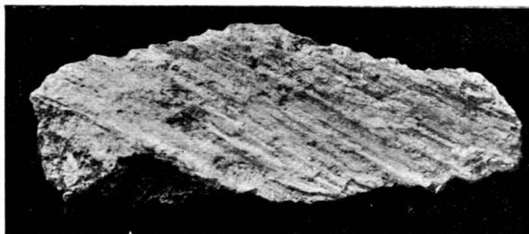
Fig. 173. Kastell von S. Wolfgang. Abdruck von Holzrinde in den Kanälen.
