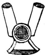
Fig. 77. Wasserteilhahn aus Bronze; Schema
