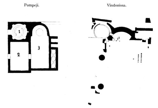
Fig. 37. Römische Thermen. 1 Cella frigidaria, 2 Caldarium, 3 Tepidarium. Masstab 1: 600.
