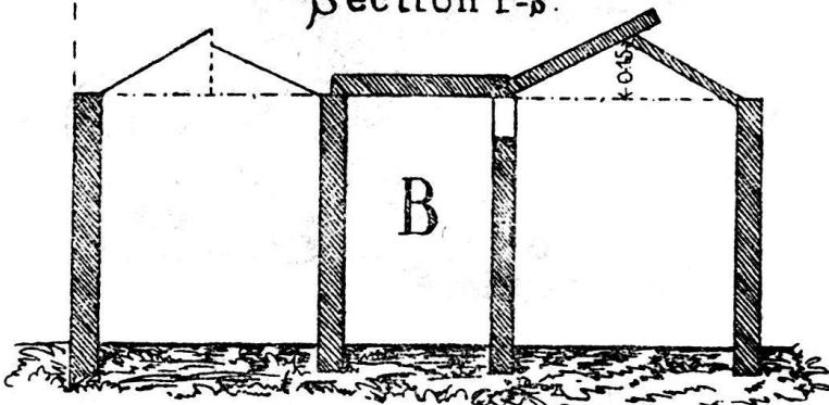
Stück Stein, an dessen verticalem Rand Nuthen zur genauern Verbindung mit den Querstücken a, d, d, m und m, b, c, c, o und o, p angebracht sind. Letztere sind ebenfalls aus Einem Stück. Die Steinplatten sind roh, von ungleicher Dicke, an der Oberfläche unbearbeitet, die Kanten ungenau, die Nuthen ebenfalls schlecht ausgeführt und es scheint, dass man zur Zeit der Errichtung des Grabes den Meisel noch nicht kannte.
