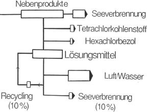
Materialströme aus der PVC-Produktion. Die Materialströme sind lediglich abgeschätzt. Diffuse Verluste bei der Produktion, der Verarbeitung und dem Gebrauch sind nicht berücksichtigt.
