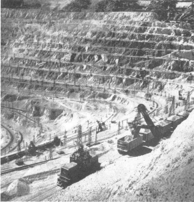
Kupferabbau: Löffelbagger beladen Eisenbahnwagen mit Kupfererz
