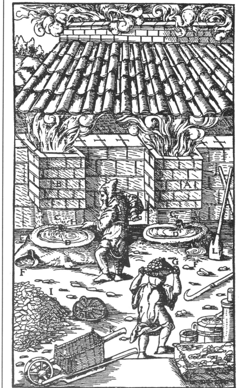
Schachtföhen wie sie im Mittelalter zum Rösten der schwefelhaltigen Kupfererze verwendet wurden, nach Georg Agricola 1556
