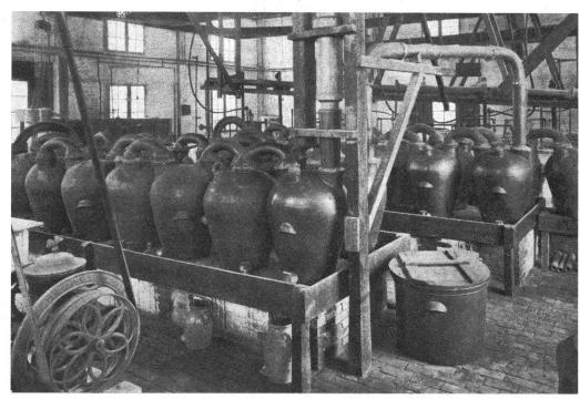
dioxid und der Sauerstoff, die an der Anode frei werden, werden in Woulffsche Flaschen gefüllt, die Wasser enthalten. Es entsteht Salpetersäure. Aus: H. Becker, Die Elektrometallurgie der Alkalimetalle, Halle 1903
