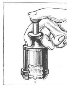
Abb. 2. Senfgefäß, das den Senf vor dem Austrocknen sicher schützt und trotzdem eine bequeme Entnahme gestattet.
