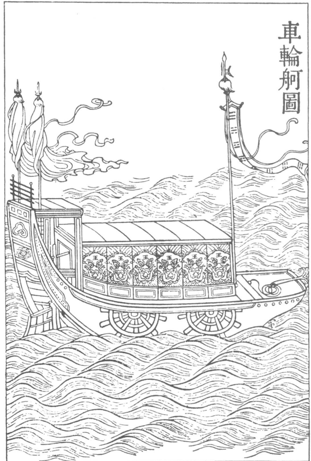
Kriegsschunken aus dem 11.–12. Jahrhundert wurden durch Tretmühlen und Schaufelräder angetrieben, um von Wind und Flußströmung unabhängig zu sein
