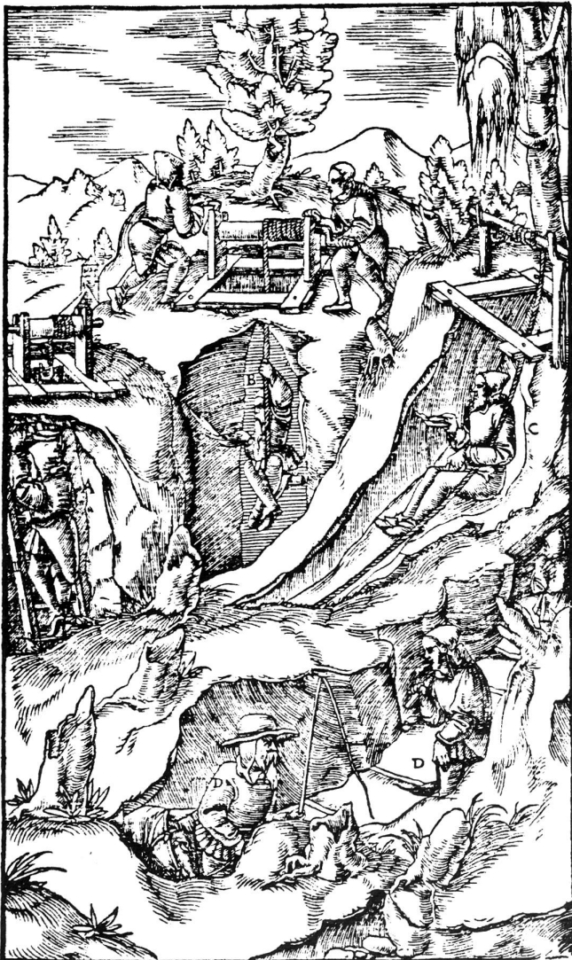
Ein Bergmann, der auf der Fahrt einführt A. 55 Einer, der auf dem Knebel sitzt B. Einer, der auf dem Leder einführt C. Auf Stufen, die im Gestein hergestellt sind, Einführende D.
