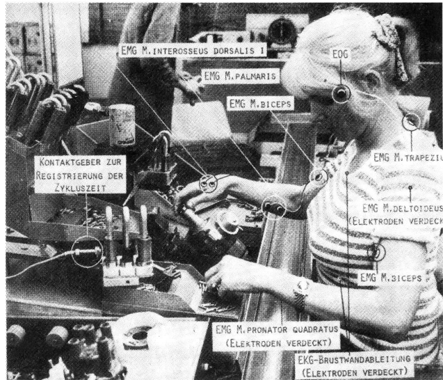
Erläuterungen ergonomischer Experimentalmethoden zur Ermittlung von Belastungsgrößen an einem Montagearbeitsplatz in der Elektroindustrie
