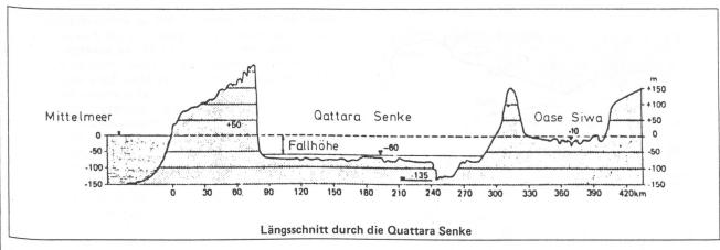
liegt. Dieser Höhenunterschied entspricht einer mittleren Fallhöhe und ließe sich zur Energiegewinnung nutzen, vorausgesetzt, man bringt das Wasser dort hin. Hier stellt sich nun dem Ingenieur die erste große Schwierigkeit entgegen. Die Senke liegt 76 km von der Wasserquelle, dem Mittelmeer, entfernt, abgeschirmt von einer Hügelkette mit Höhenunterschieden von 50–200 m.
