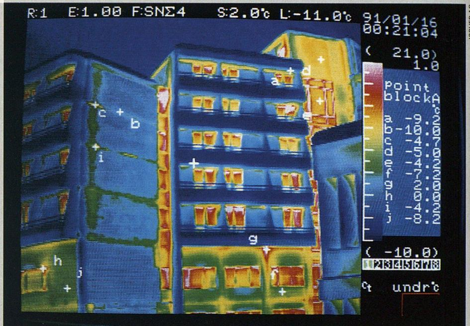
Die Fassadenthermografie einer beheizten Gebäudegruppe zeigt Wärmebrücken. Am meisten Wärme geht bei den rot/gelben Flächen verloren. Derartige Aufnahmen sind Bestandteil einer Motivationskampagne, die ein privates Unternehmen\* mit Unterstützung von Energie 2000 anbietet. Nebst einer Analyse wird dem Eigentümer der Liegenschaft ein Massnahmenpaket geliefert. Darin sind auch die Kosten aufgeführt. Die Kampagne läuft noch bis April 1999.
