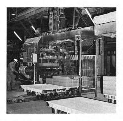
Oben: Auf solchen automatischen Drehtisch-Steinpressen erhält der Kalksandstein seine endgültige Form. Selbsttätige Stapelgeräte stellen die Steinrohlinge auf Rollwagen, die in die Härtekessel gefahren werden.
