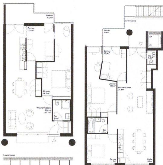
Grundrissbeispiele aus den beiden Gebäuden. In beiden reihen sich die Wohnungen jeweils seitlich aneinander. Die langgezogenen Grundrisse bedingen teilweise verschachtelte Raumabfolgen und Durchgangszimmer.
