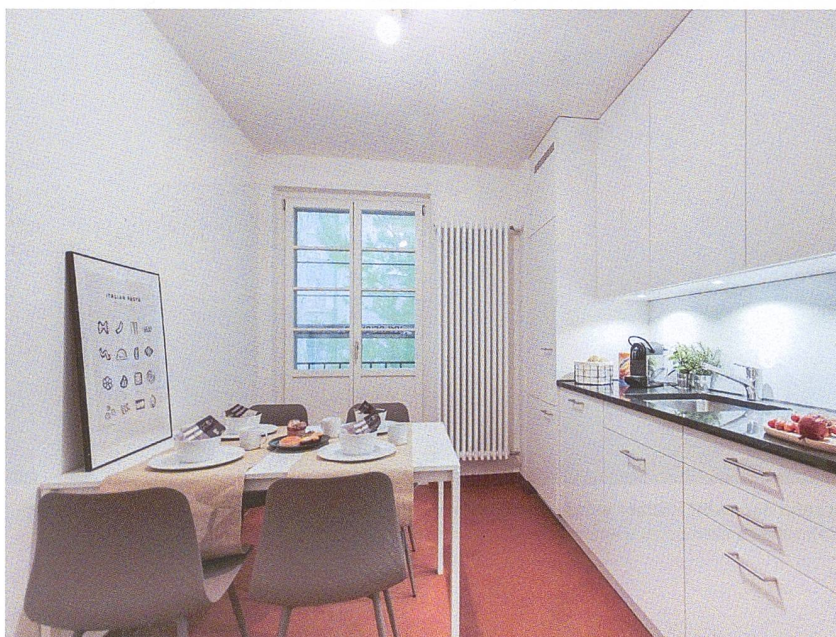
Die Küchen und Bäder waren veraltet. Um in den Nasszellen mehr Platz zu schaffen, wurden die Wände zu den Küchen etwas versetzt (siehe Plan unten), ansonsten blieben die Grundrisse unverändert. Die alten Tonsteinfliesen und Holzböden hat man erhalten und aufgefrischt.
