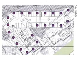
Bei der Siedlung Lerchenhalde kann dank Simulation die Hinterfüllung der Erdsonden verbessert und so auf zwei Bohrungen verzichtet werden. Dies ermöglicht eine aus energetischer Sicht bessere Anordnung der Sonden mit mehr Abstand.
