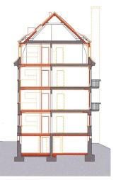
Die baulichen Massnahmen waren so umfangreich, dass die Instandsetzung in unbewohntem Zustand erfolgte. Teils mussten Böden und Decken bis auf die Rohkonstruktionnen zurückgebaut werden.
