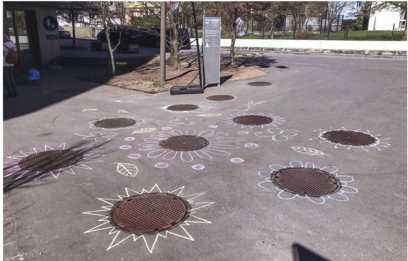
Unter einem Wendeplatz wurden auf einer Fläche von 60 Quadratmetern acht Bioreaktoren eingelassen. In ihnen wird das Grau- und das Schwarzwasser aus 50 Wohnungen, zwei Kita-Gruppen und einem Bistro gereinigt.
