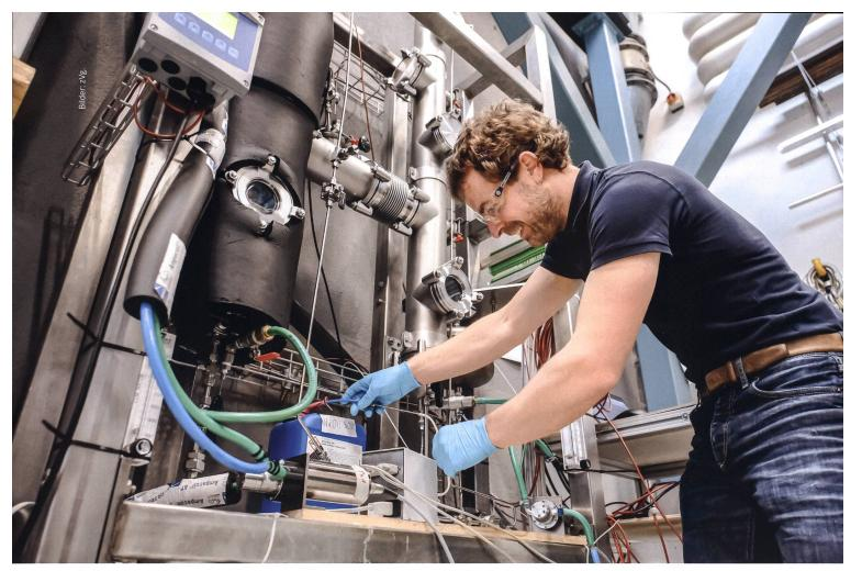
Die Empa hat eine vielversprechende chemische Speicherwärmepumpe entwickelt, die mit Natronlauge funktioniert. Der Lauge wird im Sommer Wärme zugeführt, die sie beim Verdampfen speichert und im Winter durch Zufügen von Wasser wieder abgibt.
