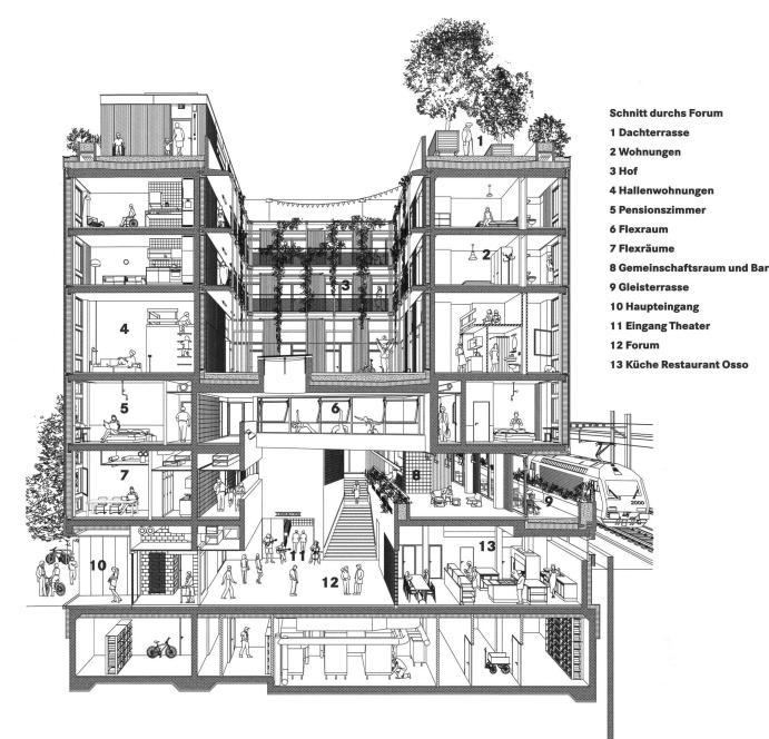
schlanke Treppenhäuser, dazwischen eine Installationsschicht. Ein Stakkato aus bodenhohen, aber schmalen Fenstern macht im 18 Meter tiefen Baukörper bis spät in der Planung flexible Raumteilungen möglich. Das suffiziente Ergebnis: Mit weniger als dreissig Quadratmetern Flächenbedarf pro Person schlug die Genossenschaft sogar ihren eigenen Rekord bei der Kalkbreite, Gemeinschaftsräume mitgerechnet. Die nächste Generation kann dann alle Wände auch anders anordnen.
