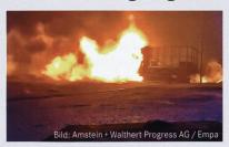
Die brennbaren Elektrolyte einer Elektroautobatterie erzeugen Stichflammen.
