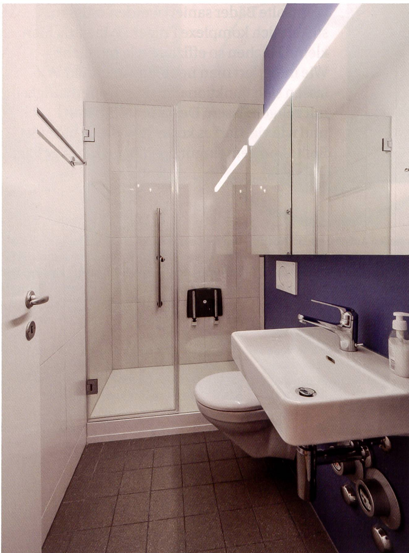
Die Wohnstadt erneuerte Bäder an der Oetlingerstrasse in Basel. In den kleineren Wohnungen baute sie Duschen ein. Wegen der engen Platzverhältnisse sind sie mit Drehtüren ausgestattet. Zudem verzichtete man auf Unterbauschränke.
